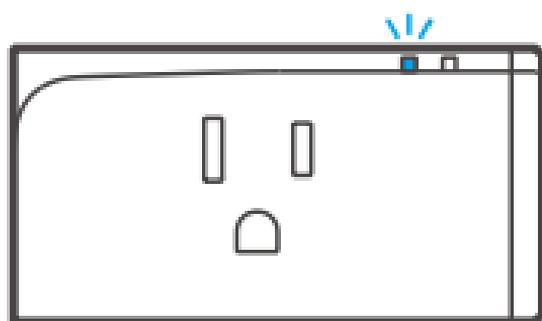
Después de encender, el dispositivo ingresará al modo de emparejamiento rápido (Touch) durante el primer uso. El indicador LED Wi-Fi cambia en un ciclo de dos parpadeos cortos y uno largo.
